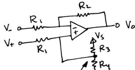
$$V_{bias} = \frac{R_4}{R_3 + R_4} V_s$$
